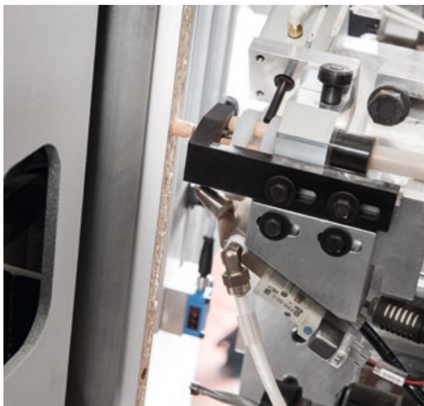
Gruppo per la gestione della foratura e dell'inserimento di colla e spina.
